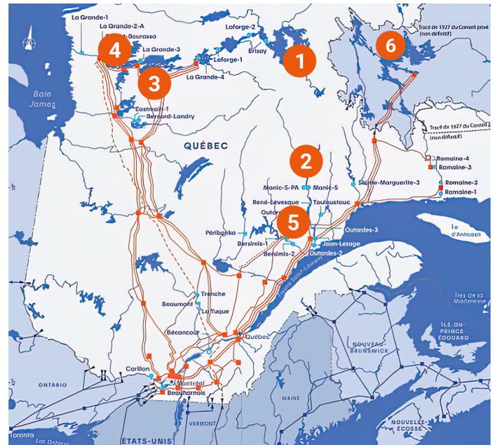
Figure 2 : Les lignes de transport à 735 kV (en orange) et les principaux réservoirs cerclés en rouge [6]
